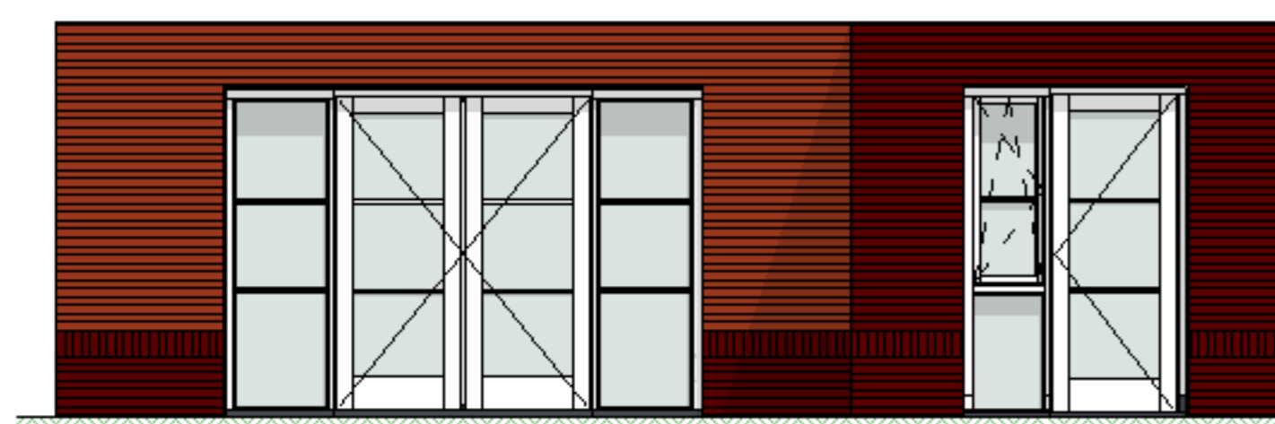
20-08 extra gevelkozijn voorzien van deur en zijlicht met draaikiep raam achtergevel
